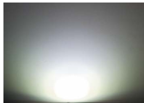
Рис. 5. Световой факел со светодиодом с неравномерным угловым распределением цветности
