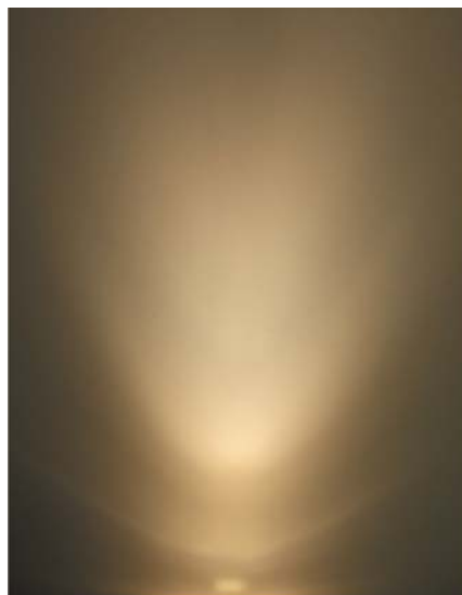
Рис. 3. Светораспределение прозрачной линзы со светодиодом с равномерным угловым распределением цветности
