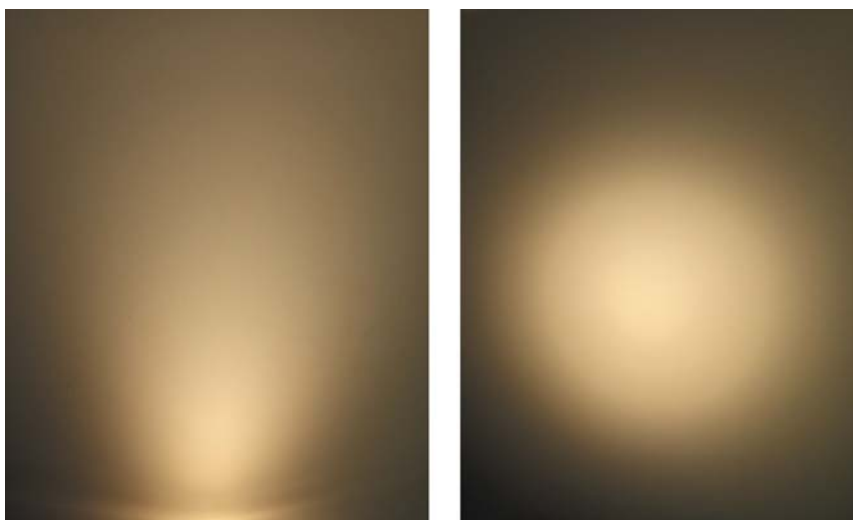
Рис. 4. Светораспределение линзы с покрытием с качественным светодиодом
