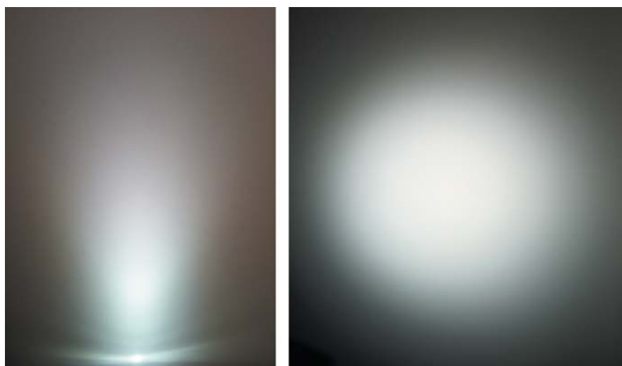
Рис. 7. Светораспределение линзы с покрытием со светодиодом с неравномерным угловым распределением цветности
