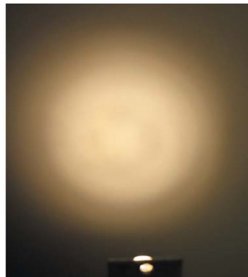
Рис. 3. Светораспределение прозрачной линзы со светодиодом с равномерным угловым распределением цветности
